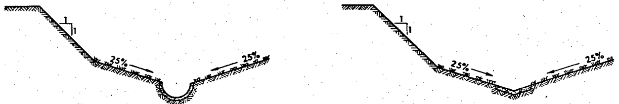
Canaletas de Concreto
